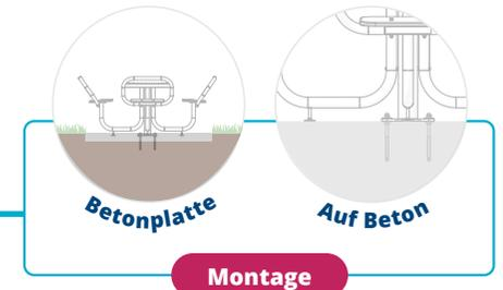
Wählen Sie zwischen Bodenmontiert (Beton) oder Montage auf einer Betonplatte
